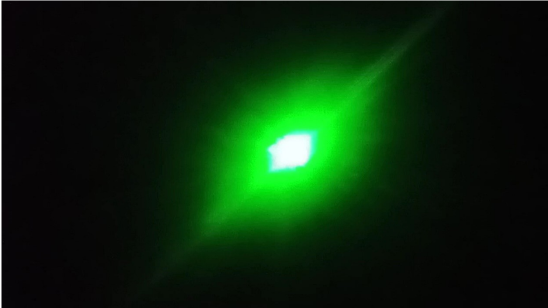
Рисунок 2 - Дифракционная картина рассеяния на ансамбле деформируемых эритроцитов.
