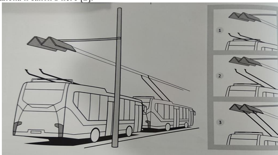
Рис. 1. Схема установки токоприемников.
