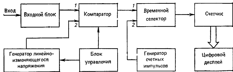
Рис.4. Структурная схема устройства для преобразования напряжения в интервал времени.
